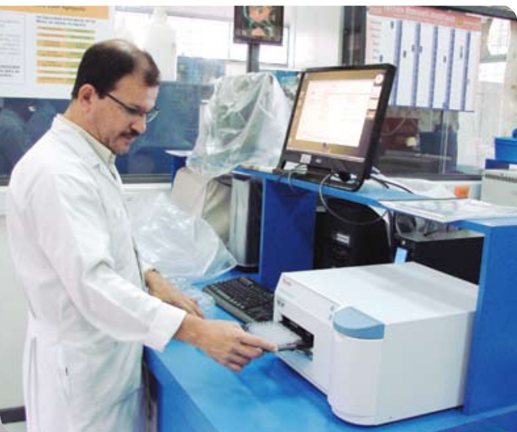
Eduardo Umaña del CINAT utiliza el espectro multiscan con el fin de determinar la capacidad antioxidante de la miel.
