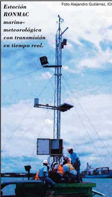
**Estación RONMAC marino-meteorológica con transmisión en tiempo real.**
